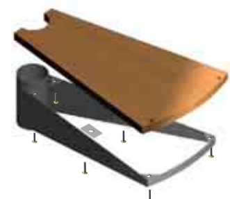
Modulo con agujeros para barandillas, en escalón de madera atornillado a la base.
