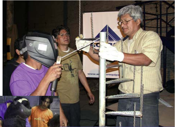
Participantes armando una escalera de caracol a escala y tomado en cuenta los cálculos para su fabricación
